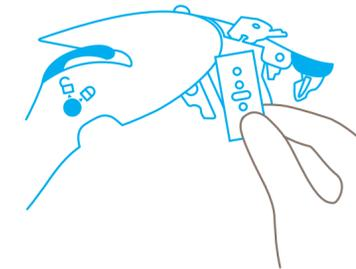
Ahora, puede levantar la cubierta para girar o cambiar la hoja.
