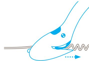
La guía de plástico aplanará el material a cortar, facilitando el corte de film y papel.
